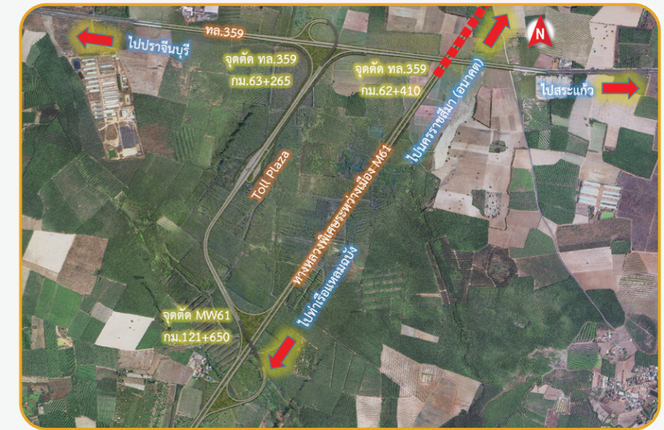
รูปแบบทางแยกต่างระดับ Double Trumpet Interchange
