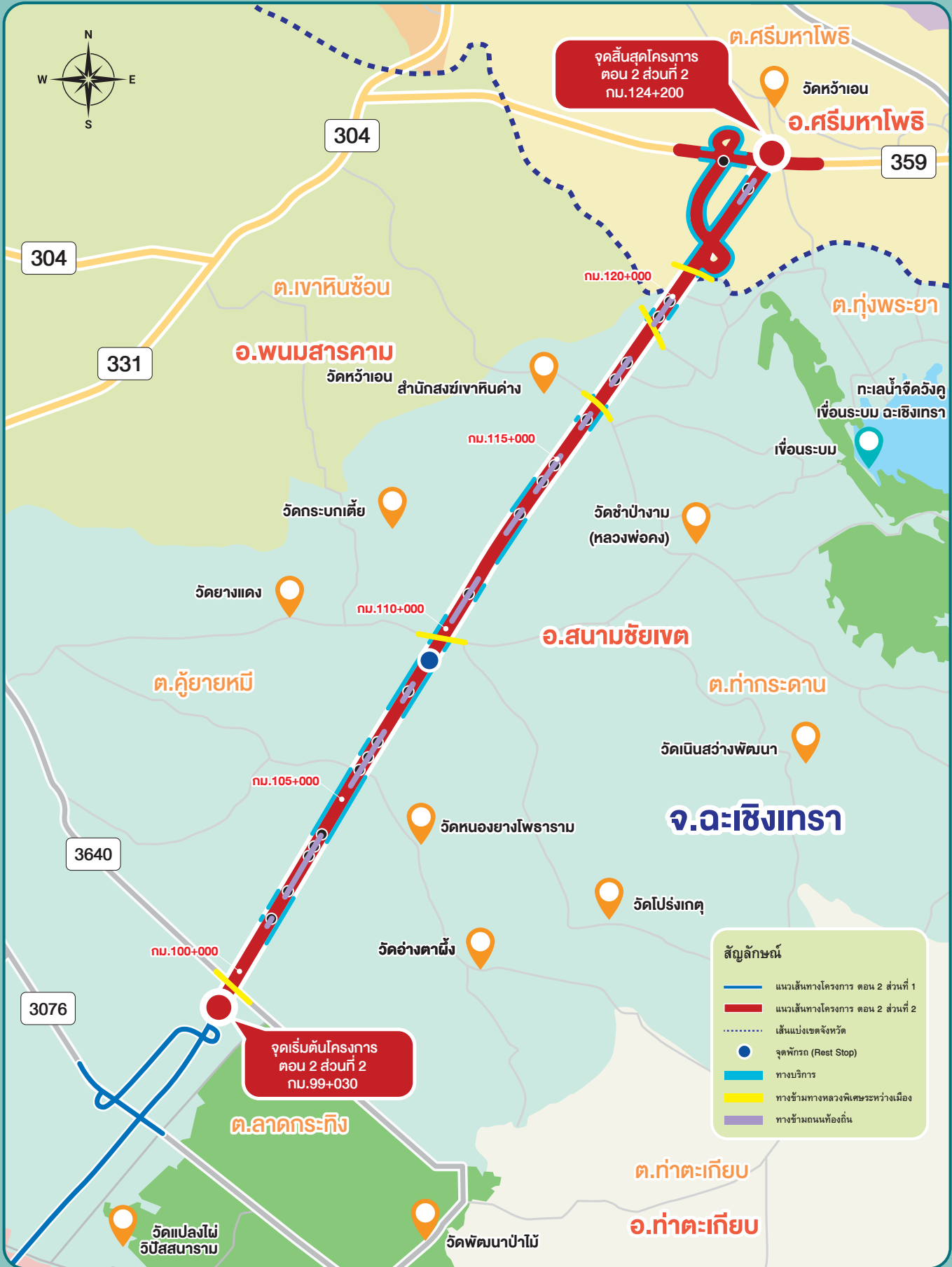
แผนที่แนวเส้นทางแสดงตำแหน่งทางบริการ ทางลอด และทางข้ามของโครงการ
