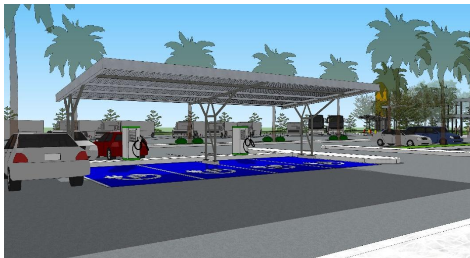
สถานีบริการอัดประจุไฟฟ้าสำหรับรถยนต์พลังงานไฟฟ้า
