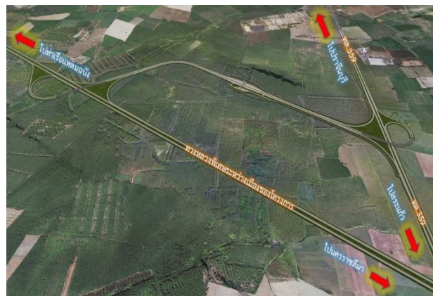
รูปที่ 7-12 รูปแบบทางเลือกที่ 3 Double Trumpet Interchange
