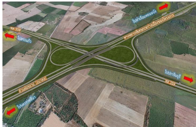
รูปที่ 7-10 รูปแบบทางเลือกที่ 1 Partial Cloverleaf Interchange
