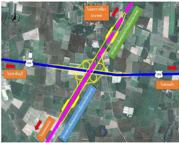
รูปที่ 7-11 รูปแบบทางเลือกที่ 2 Cloverleaf Interchange
